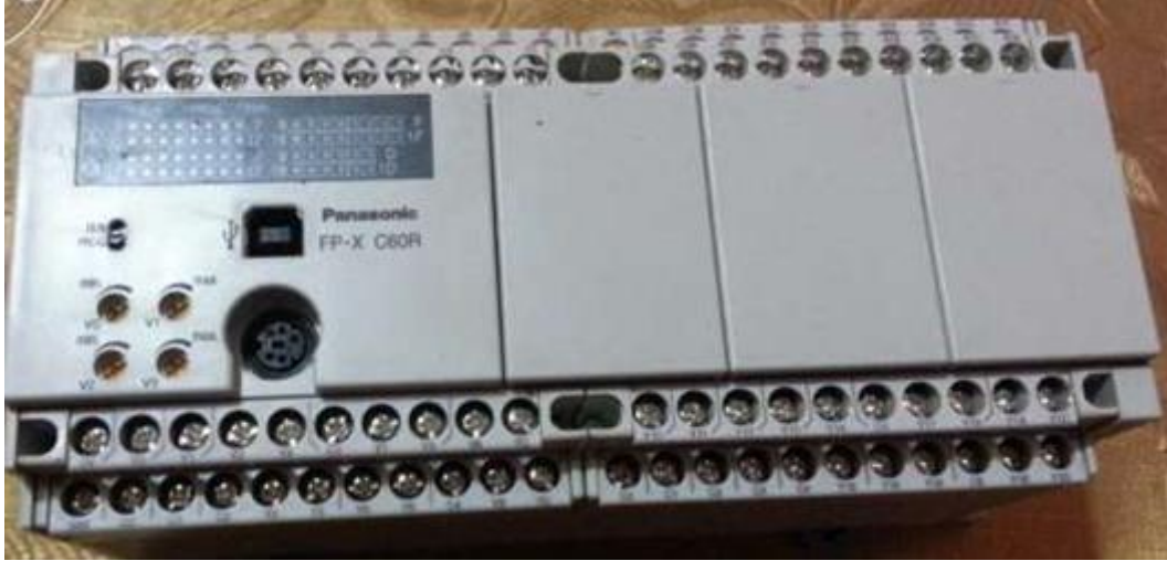
Şekilde 4 adet (V0,V1,V2,V3) potansiyometre görülmektedir.
